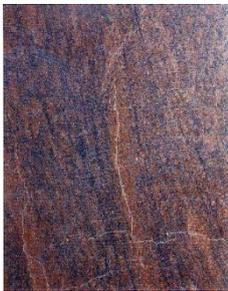
Plaque originale avec cracks et petit trous
